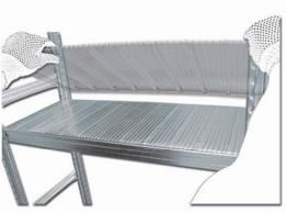
2. Se ensamblan las vigas a los postes a la altura que desee de acuerdo a las cejas del poste, las vigas tienen un riel el cual debe estar siempre viendo hacia arriba.
